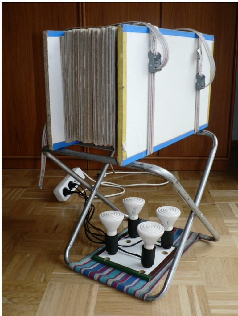
Abb. 2: Aufgebaute Presse ohne „Kunststoffumhang“
