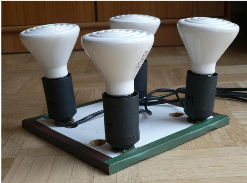
Abb. 1: Infrarotstrahler, Elstein, Typ IOT, 100 W
